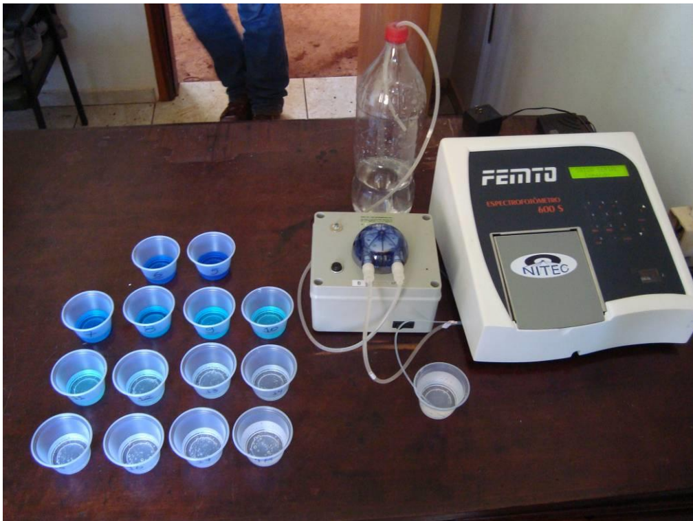
Figura 5: Espectrofotômetro utilizado para a determinação da absorvância.
