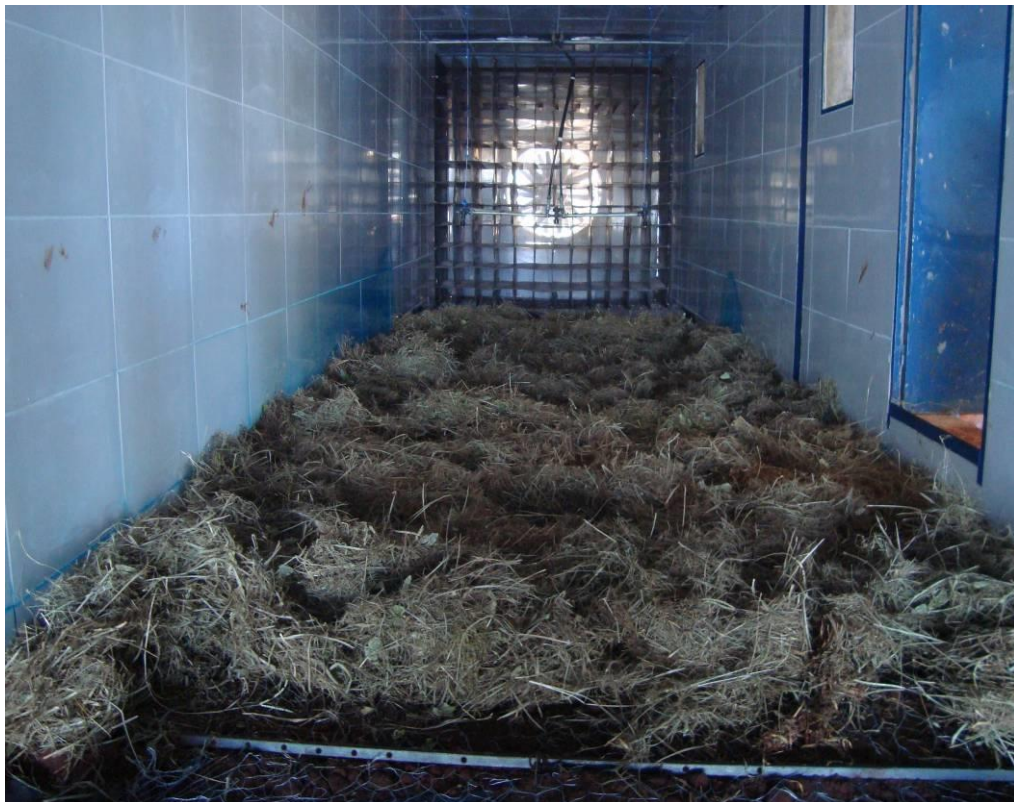
Figura 2: Camada de palha sobre o solo no piso do túnel de vento.
