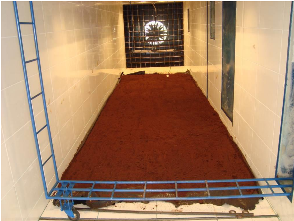
Figura 1: Distribuição da camada de solo no piso do túnel de vento.
