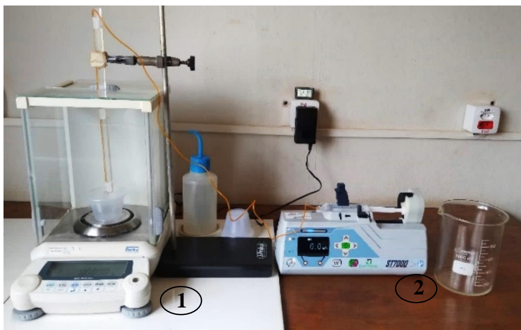
Figura 6 – Balança de precisão (0,001 g) (1) e bomba de infusão modelo Samtronic ST7000 com fluxo de 6 mL h -1 (2), utilizada para a determinação da tensão superficial. Foto: GRANDE, K.C.O.
