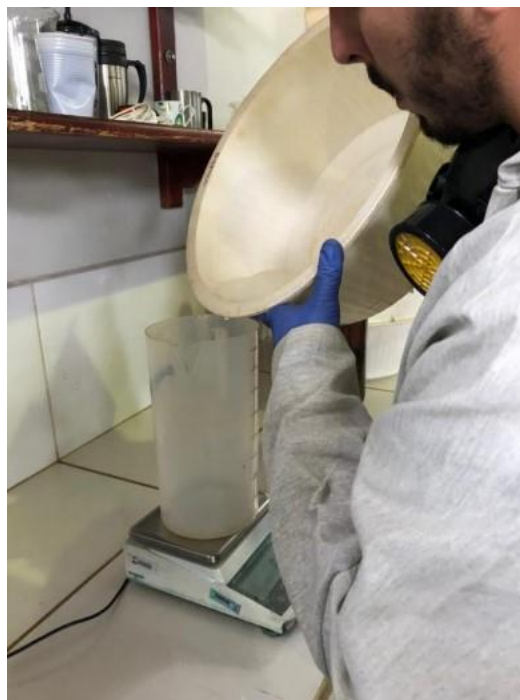
Figura 10 – Pesagem em balança de precisão (0,001 g) do volume de água coletado dos recipientes coletores. Foto: NITEC/UENP, Bandeirantes/PR.
