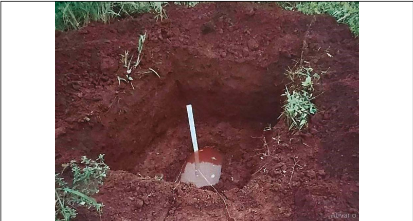
Figura 01: Teste de percolação do solo.
