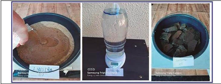
Figura 05: Processo determinação do volume de água/vazios.
