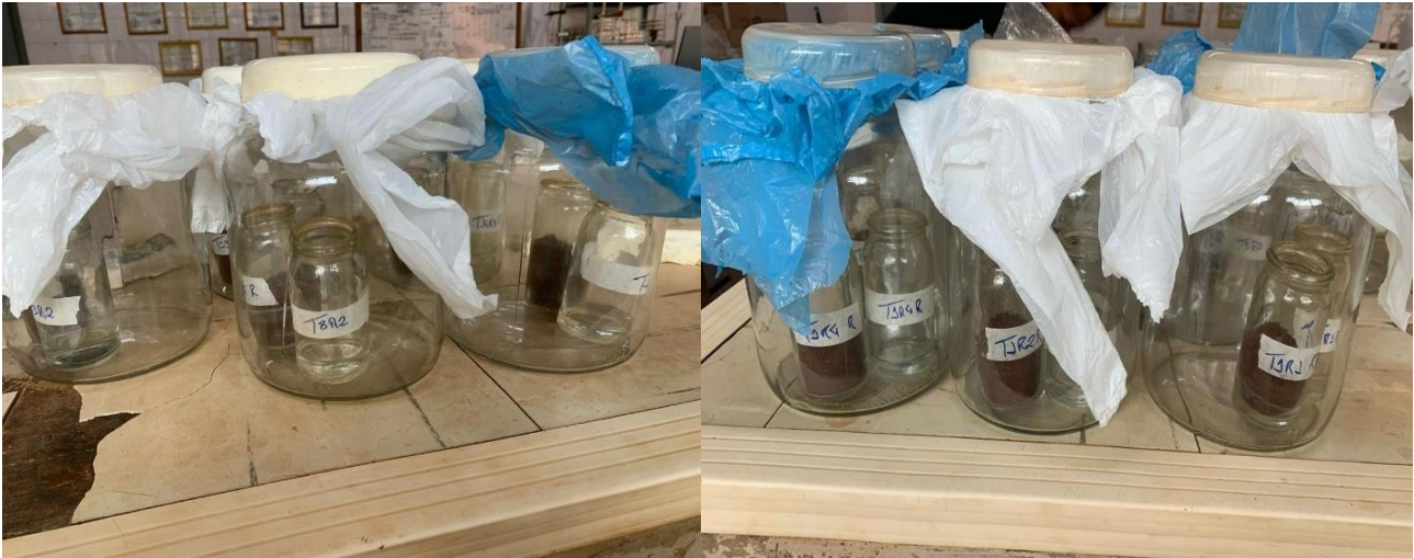
Figura 11: Incubação do solo com hidróxido de sódio (NaOH)
