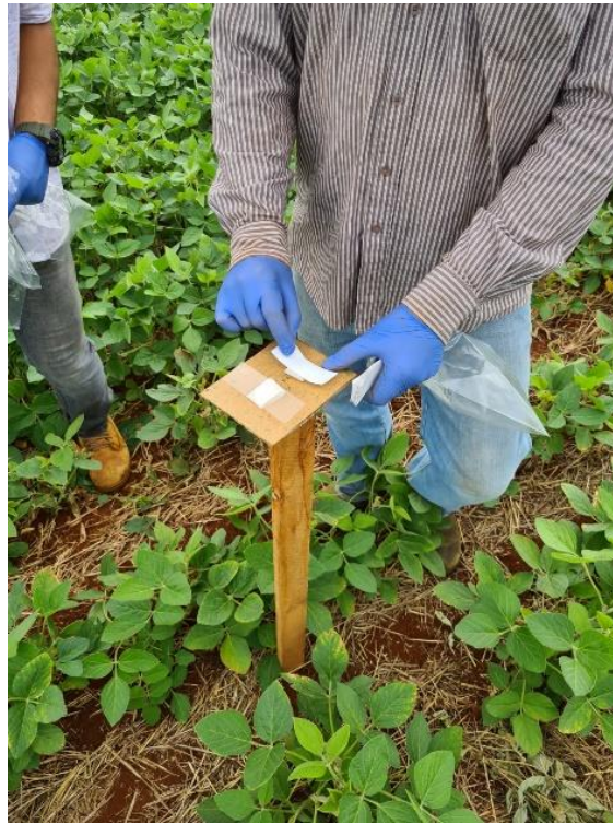
Figura 1.8. Coletores de depósito e cobertura sob a superfície a 0,90 m do solo. Foto: Silva, A.S. (2022).
