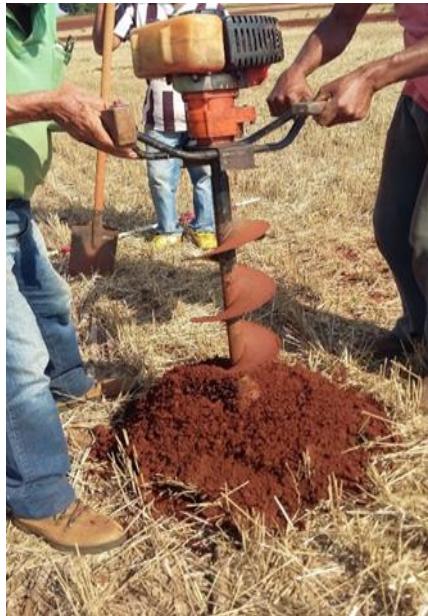
Figura 6. Aspecto geral do perfurador de solo à gasolina
