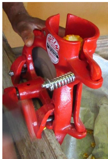
Figura 11. Aspecto geral do debulhador manual
