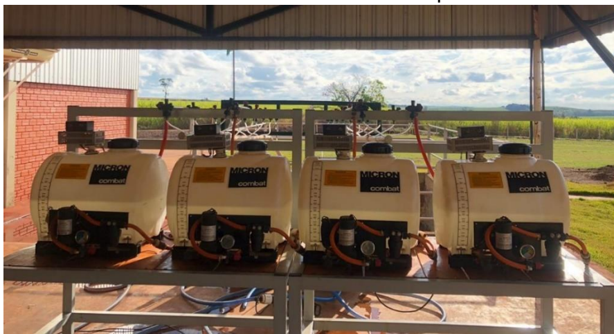
Figura 1: Pulverizador modelo Pulsar 100 fabricado por Micron S/A.
