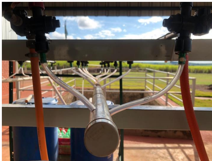
Figura 2: Sequência de pontas instaladas na barra Columbia AD 18.
