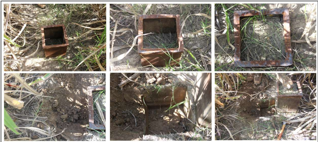
Figura 4 – Coleta da amostra com a utilização do gabarito metálico, metodologia modificada de Tropical Soil Biology and Fertility – TSBF (Anderson & Ingram, 1993)
