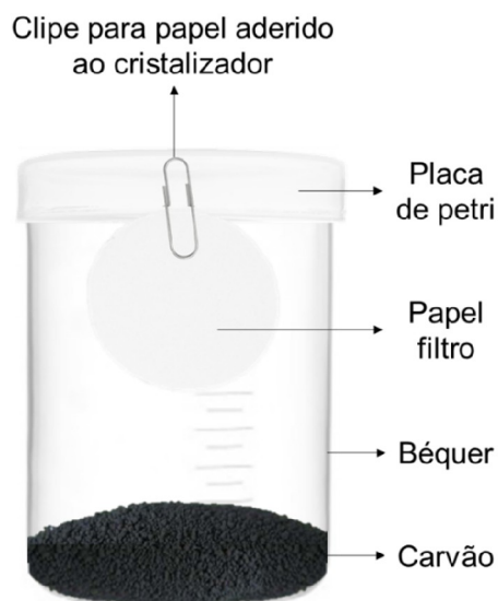
Figura 3. 1 Conjunto de materiais montados para realização do ensaio de volatilidade de produtos químicos.
