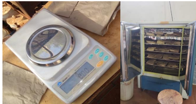
Figura 5 - Balança de precisão e acondicionamento dos sacos de papel em estufa de circulação forçada.
