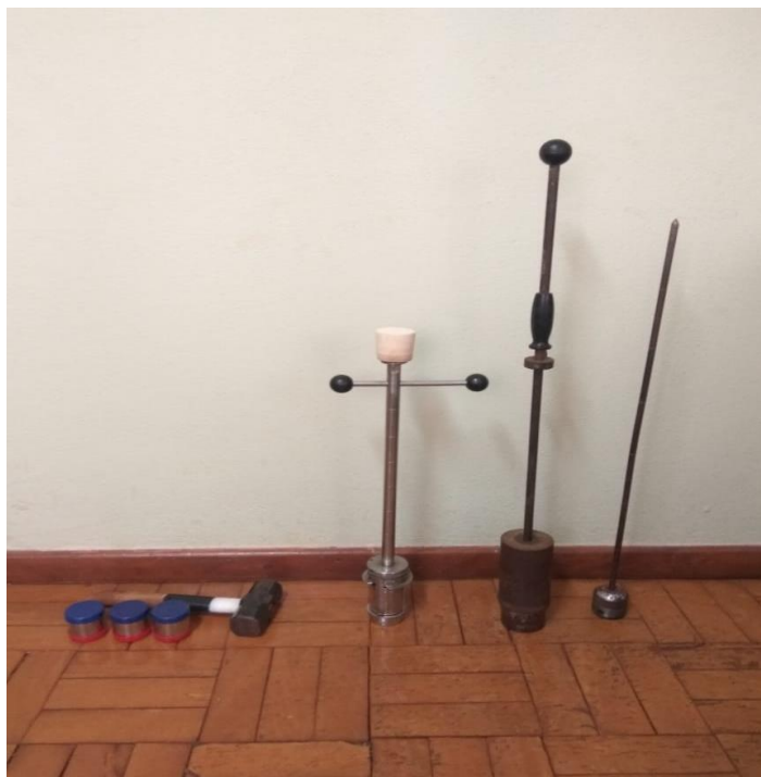
Figura 13 - Amostradores para os parâmetros físicos do solo: da esquerda para a direita: anéis volumétricos e marreta, trado amostrador para os anéis e o penetrômetro de impacto.
