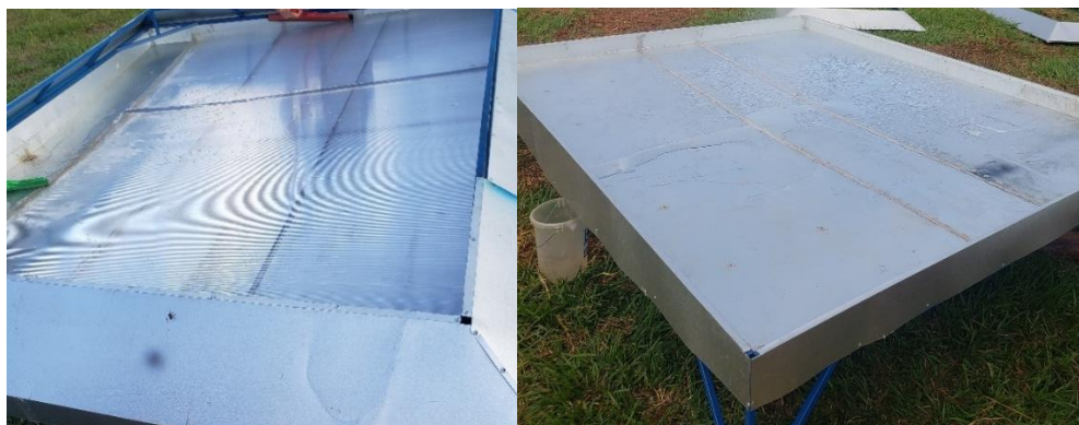
Figura 16. Base da superfície de coleta da estrutura piramidal projetada para escoamento do líquido pulverizado. Foto: Motta, A. B. O. (2024).
