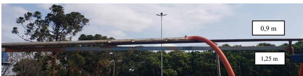
Figura 4. Visualização do suporte adicional acoplado ao braço da barra de pulverização com suas dimensões de acordo com o modelo da barra de pulverização do Condor 600 ® , Máquinas Agrícolas Jacto SA, Pompeia, São Paulo, Brasil. Foto: Motta, A. B O. (2024).
