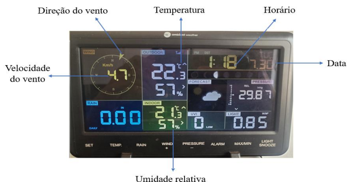
Figura 19. Descrição do console da estação meteorológica Ambient Weather, com a visualização das respectivas funções, Ambient Weather, Chandler, Arizona, Estados Unidos. Foto: Motta, A. B O. (2024).
