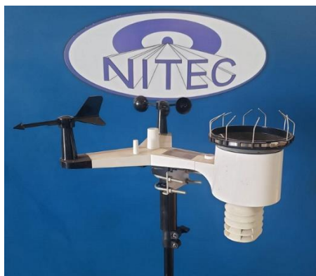
Figura 17. Modelo do equipamento da estação meteorológica Ambient Weather WS-2902, utilizada durante o experimento, Ambient Weather, Chandler, Arizona, Estados Unidos. Foto: Motta, A. B O. (2024).
