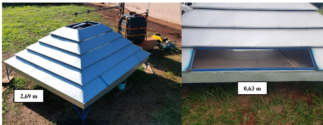
Figura 9. Visualização da estrutura piramidal contendo todos os módulos e especificação métrica da sua dimensão. Foto: Motta, A. B O. (2024).
