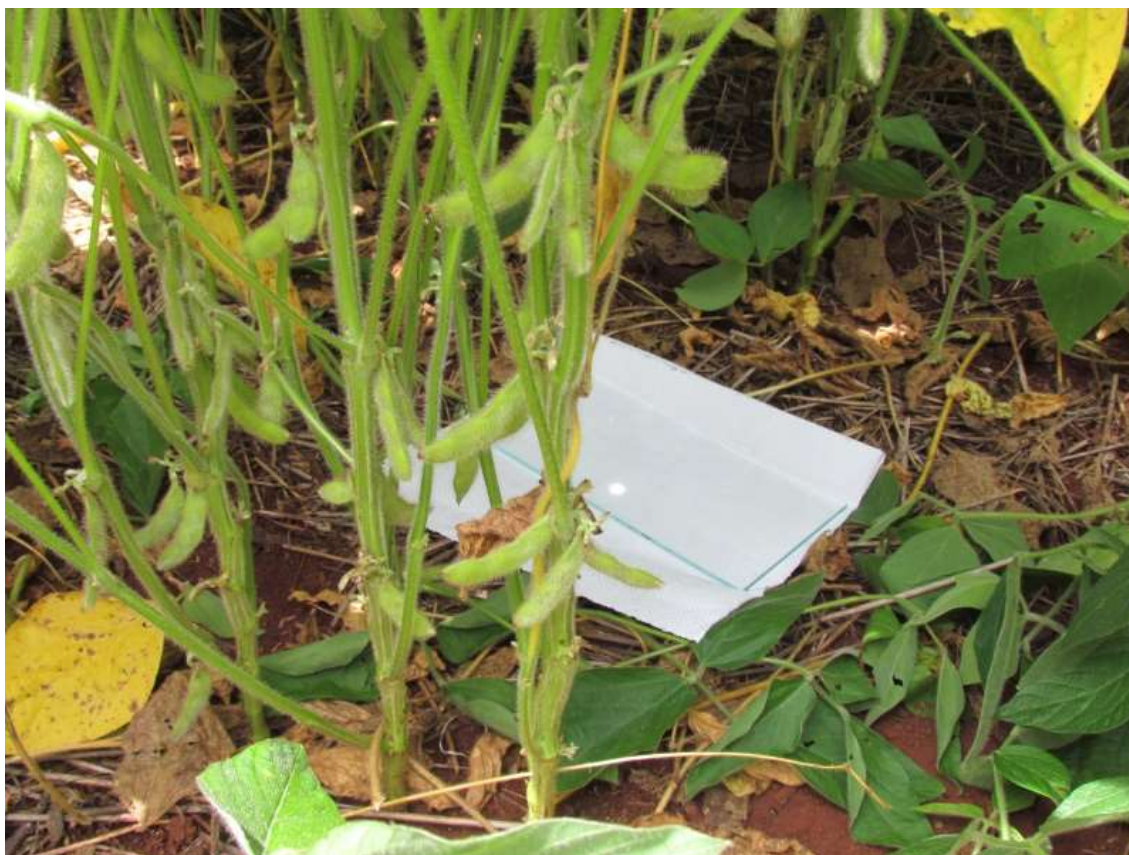
Figura 3. 1 Posicionamento das placas de vidro na entrelinha da cultura da soja para avaliação de perdas para o solo durante a aplicação de produto fitossanitário.
