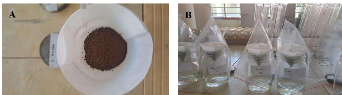
Figura 3. Procedimento para determinação da CMR. Saturação por capilaridade(A), drenagem do excesso de água por gravidade (B).
