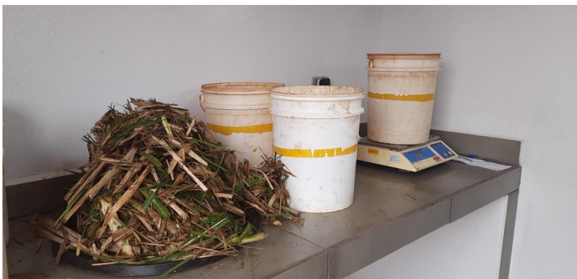
Figura 4. Estratificação e pesagem das amostras para determinação dos níveis de impureza vegetal. Foto: Santos Júnior, 2023.
