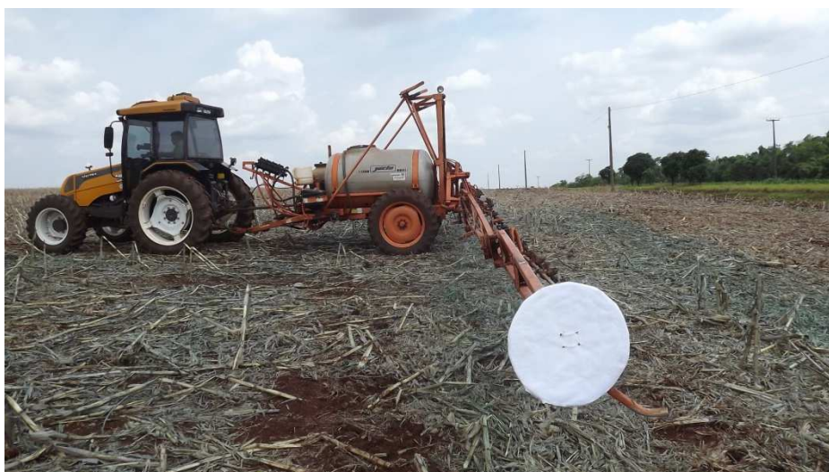
Figura 3.8. Alvo (referência de papel) fixado na extremidade da barra do pulverizador.
