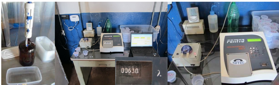
Figura 3.7. Lavagem com 40 mL de água destilada e leitura no espectrofotômetro.
