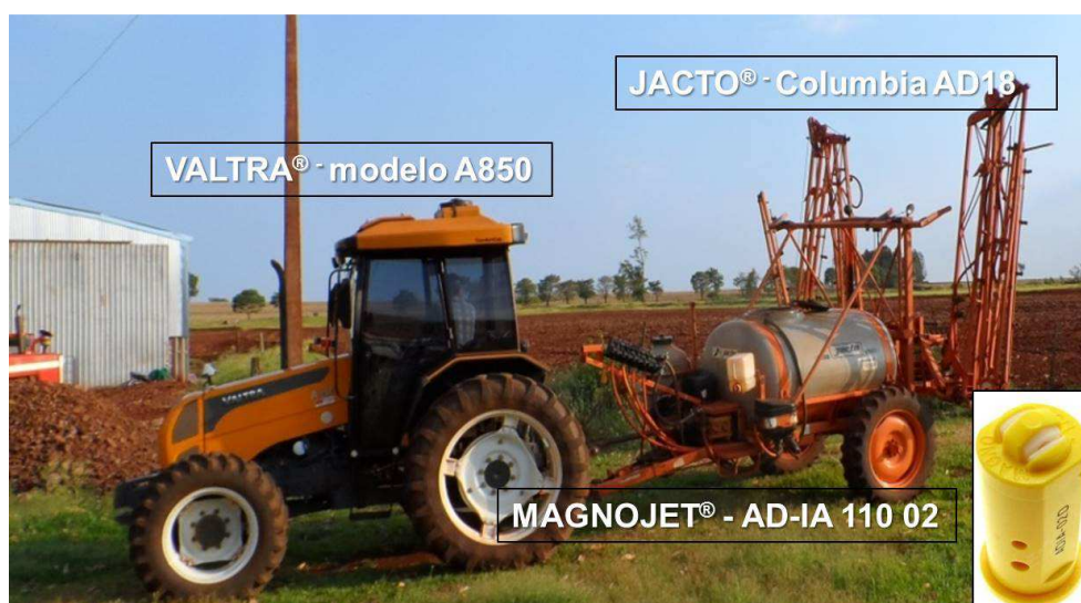
Figura 3.4. Conjunto Trator/Pulverizador (A850/AD18) e ponta de pulverização (AD-IA 110 02).
