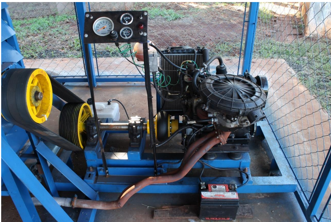
Figura 3. Sistema de transmissão motor-polia para o ventilador na geração de vento.
