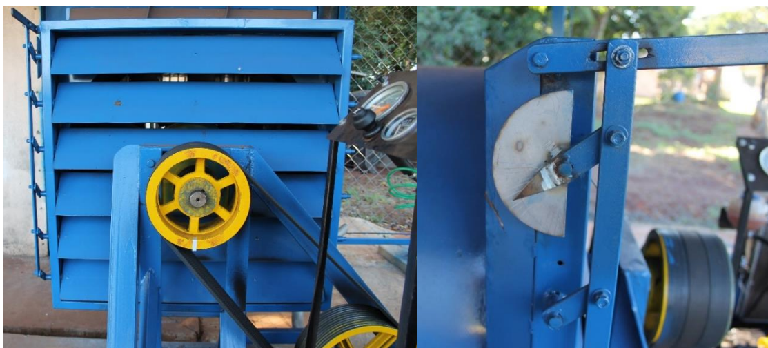
Figura 4. Sistema mecânico de fechamento e abertura de entrada de ar para o ventilador.
