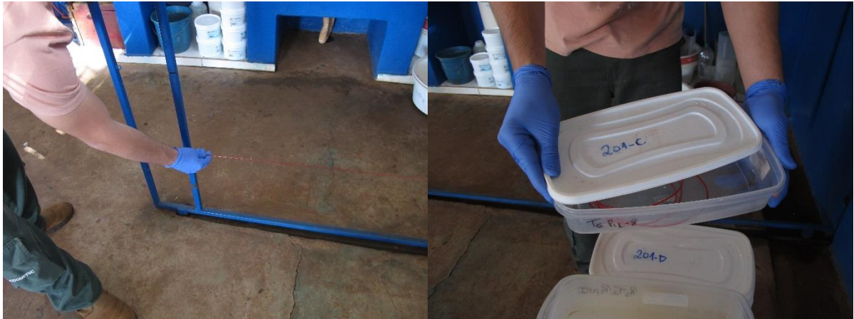
Figura 15. A) Disposição dos suportes e fixação dos fios de polietileno em diferentes alturas verticais. B) Recipiente de armazenamento e lavagem dos coletores, devidamente identificados.
