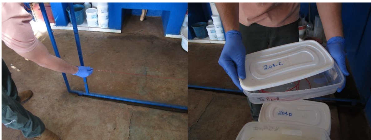
Figura 5. A) Disposição dos suportes e fixação dos fios de polietileno em diferentes alturas verticais. B) Recipiente de armazenamento e lavagem dos coletores, devidamente identificados.
