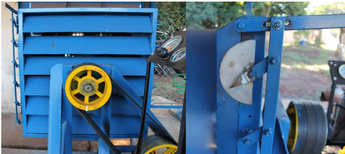
Figura 14. Sistema mecânico de fechamento e abertura de entrada de ar para o ventilador.
