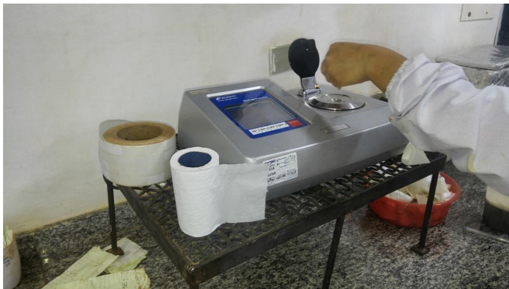
Figura 7. Amostra em refratômetro digital. Foto: Teodoro (2017).
