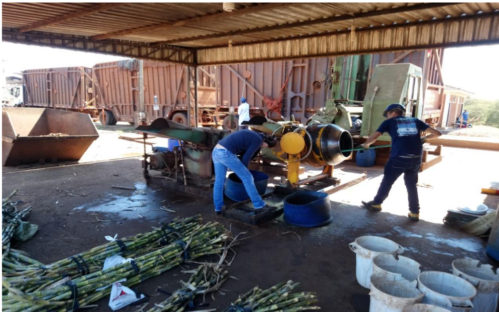
Figura 4. Desfibragem das amostras de cana-de-açúcar. Foto: Teodoro (2018).
