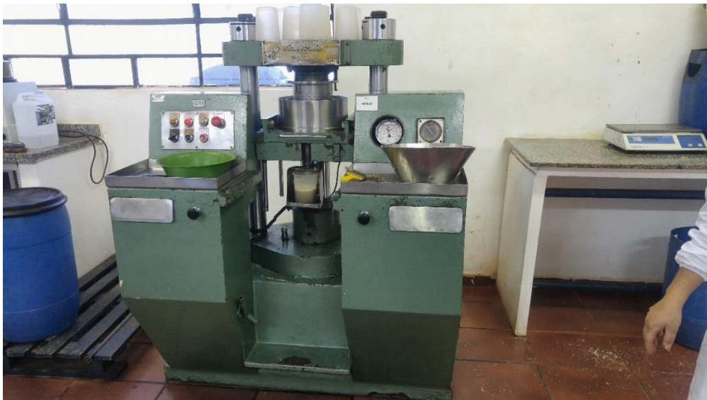
Figura 6. Amostra na prensa hidráulica. Foto: Teodoro (2017).
