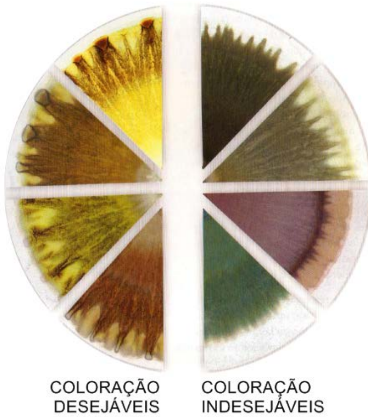
FIGURA 2.12- Padrão de cores para análise cromatográfica de solos (RESTREPO; PINHEIRO, 2011).
