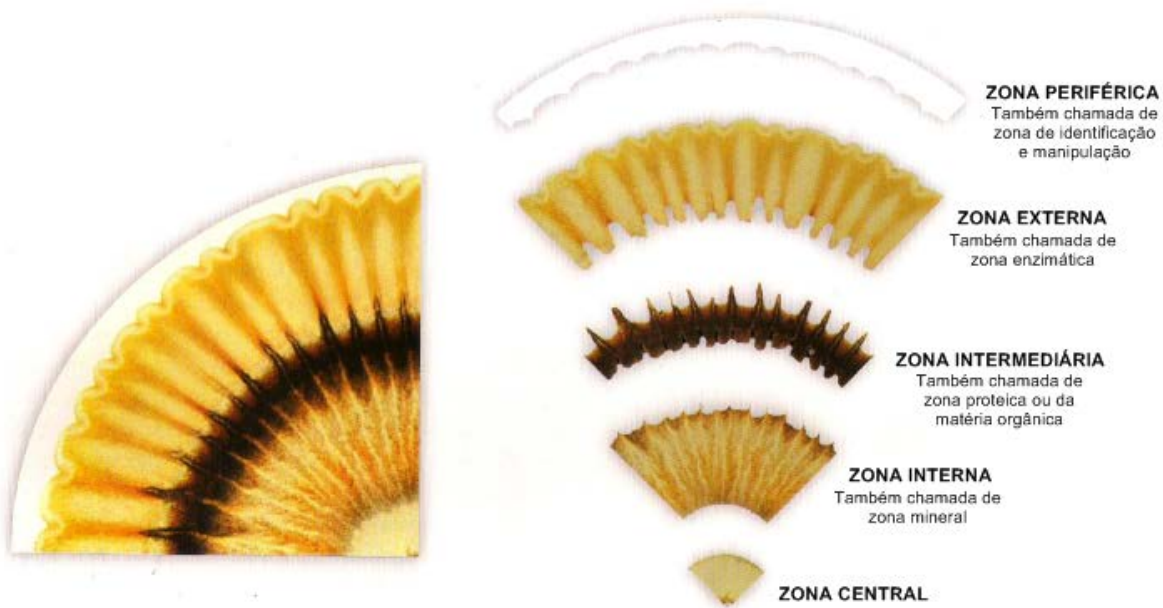
FIGURA 2.3 – Identificação esquemática das principais zonas de um cromograma (RESTREPO; PINHEIRO, 2011).
