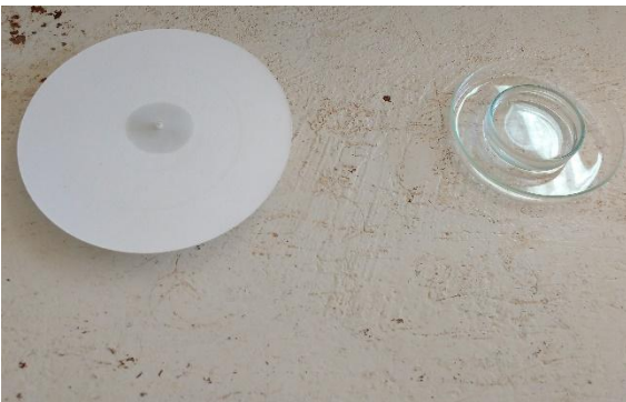
FIGURA 2.2 – Impregnação com solução de \text{AgNO}_3 a 0,5%.
