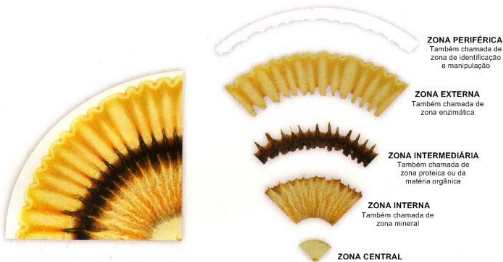
Figura 2. Identificação esquemática das principais zonas de um cromato (Restrepo e Pinheiro, 2011).
