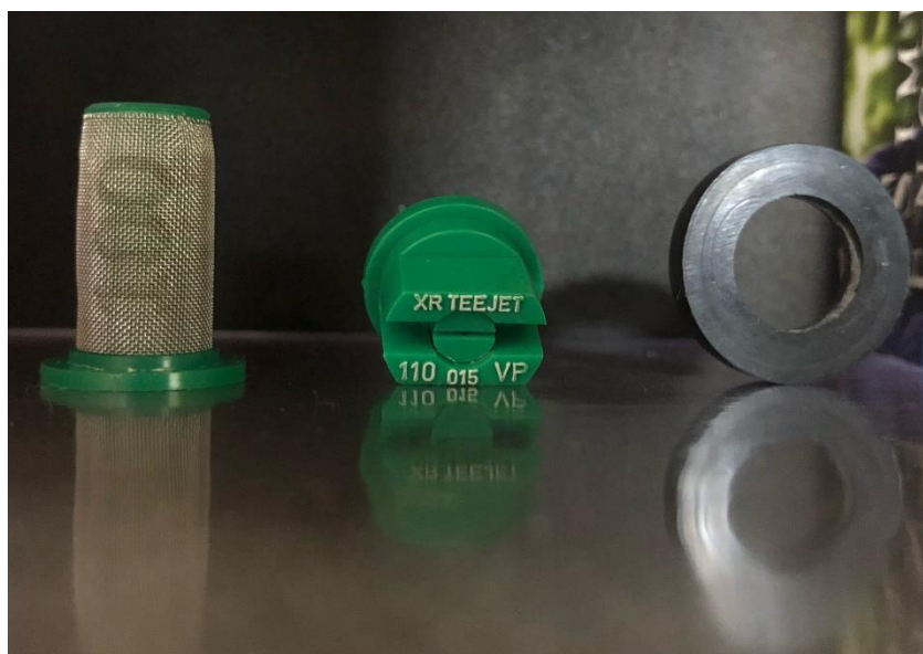
Figura 3 – Filtro de malha 100, Ponta de pulverização XR110015, Anel de vedação, utilizados para aplicação de mistura. Foto: CUNHA, W.A.B Bandeirantes/PR
