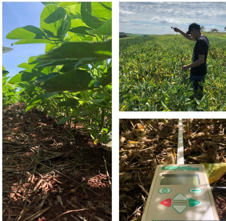
Figura 19 – Sombreamento e análise do índice de área foliar, realizada pelo ceptômetro do modelo ACCUPAR LP-80. Foto: CUNHA, W.A.B BANDEIRANTES/PR
