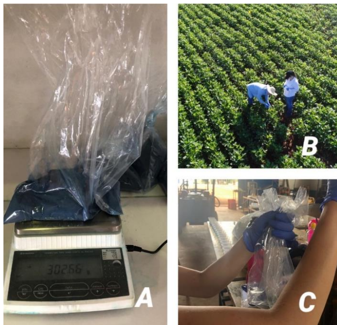
Figura 17 – A: Traçador azul brilhante (6 g L -1 ), B: Coleta das folhas, C: Lavagem do marcador nas folhas (25mL) Foto: CUNHA, W.A.B BANDEIRANTE/PR
