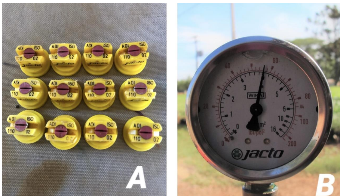
Figura 14 – A: Ponta de pulverização ADI 110-02, B: Manômetro, com pressão de 400 kPa. Foto: CUNHA, W.A.B BANDEIRANTES/PR
