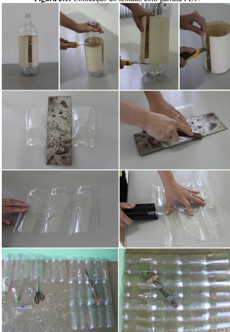
Figura 3.1: Confeção do telhado com garrafa PET.
