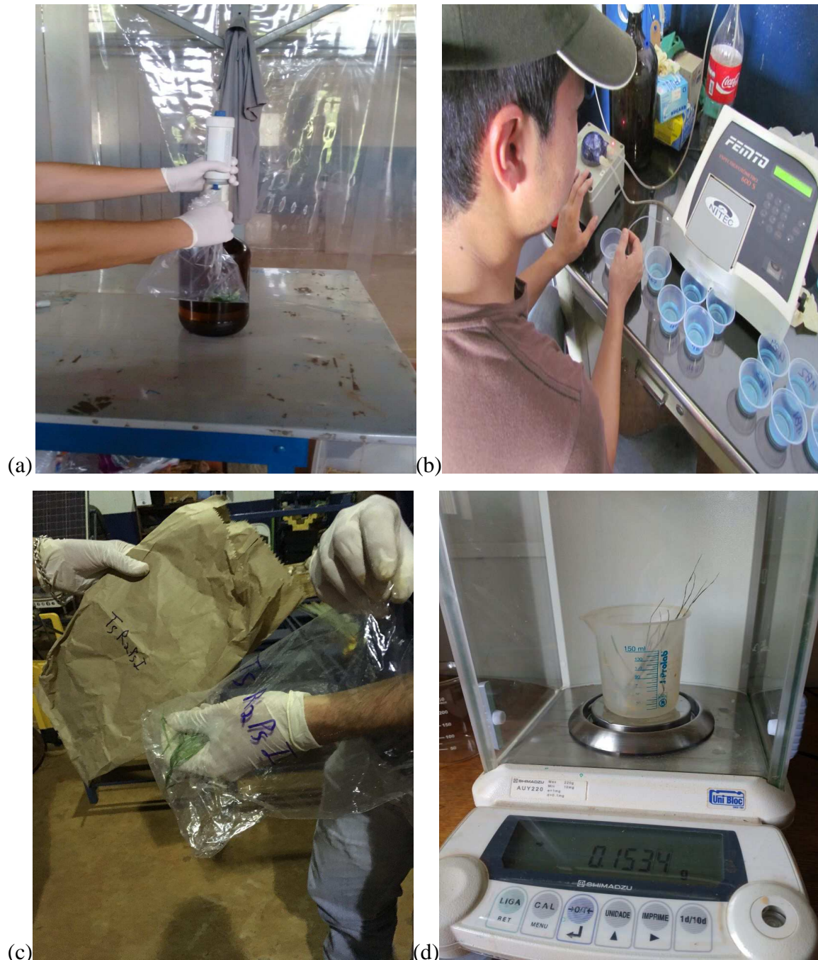
Figura 6. (a) Lavagem de perfilhos e placas. (b) Análise de absorvância em espectrofotômetro. (c) Transferência dos perfilhos para os sacos de papel. (d) Pesagem em balança analítica.
