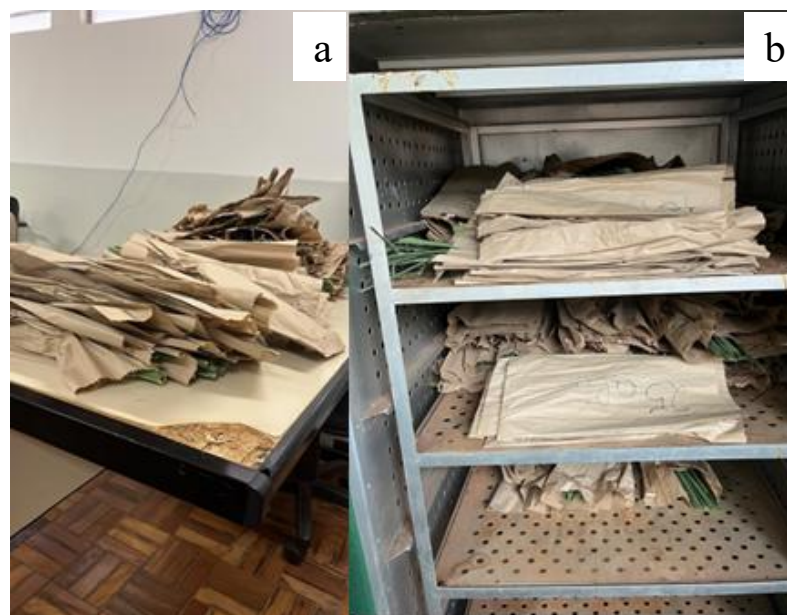
Figura 9 - Amostras separadas em sacos de papel para serem colocadas na estufa (a); Amostras secando em estufa de circulação de ar forçado, vista interna da estufa (b).
