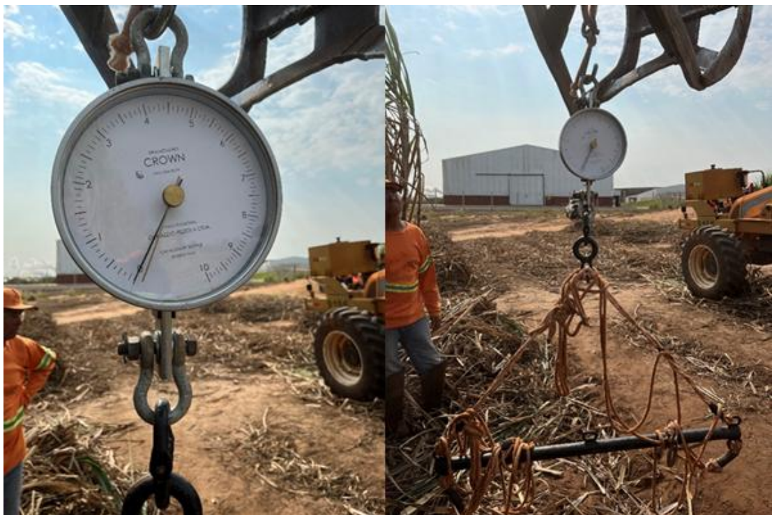
Figura 16 - Modelo da balança do tipo relógio utilizada para pesagem dos feixes inteiros de cada subparcela (esquerda); sistema completo utilizado para erguer os feixes e realizar a pesagem (direita).
