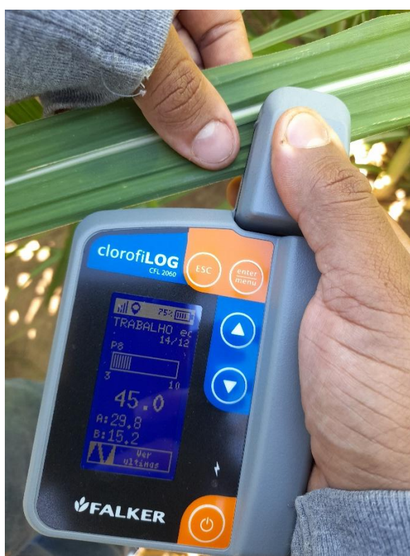
Figura 7 - Aparelho ClorofiLOG CFL 2060 realizando a medição dos níveis de clorofila da folha +1 aos 180 DAP
