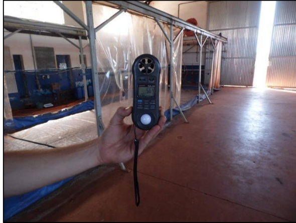
Figura 3.7. Termo-higro-anemômetro de luxímetro digital portátil, modelo THAL-300, Instrutherm® utilizado na verificação da temperatura média (°C) e umidade relativa do ar (%). Bandeirantes – PR, 2018.
