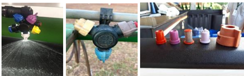
Figura 2 - Carcaça dos bicos com cinco pontas de pulverização (esquerda), com três pontas (centro) e filtro, ponta e capa (direita)
