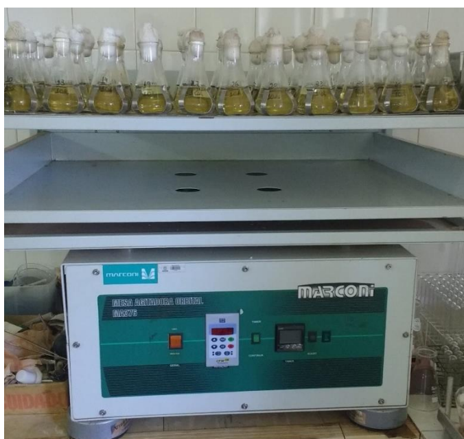
Figura 4.3 – Mesa agitadora horizontal para cultivo contínuo.
