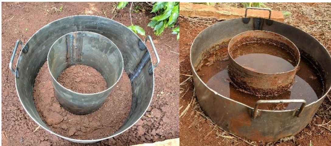
Figura 2. Infiltrômetro de Anéis Concêntricos com régua graduada no cilindro interior, anéis preenchidos com água respectivamente.
