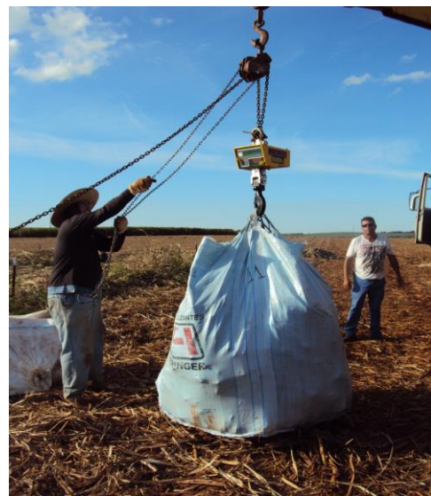
Figura 7. Pesagem com balança suspensa. Fonte: VIECELI, T. H. A. (2016).
