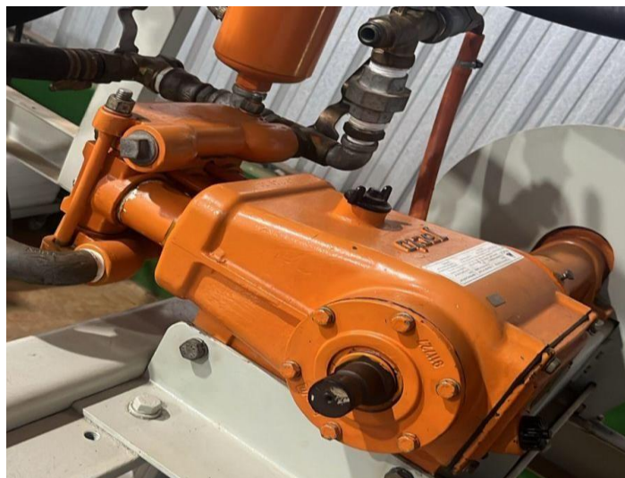
Figura 3 - Bomba de pressurização do circuito hidráulico
