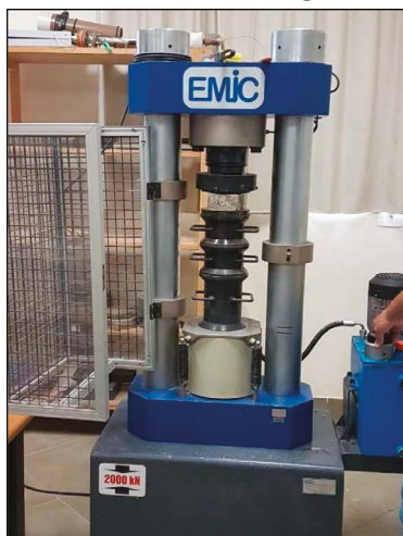
Figura 05: Ensaio de resistência à compressão.
