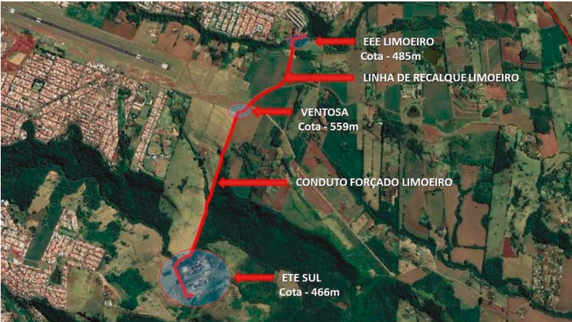
Figura 05: Traçado do coletor entre o PV de Transição e a ETE Sul.
