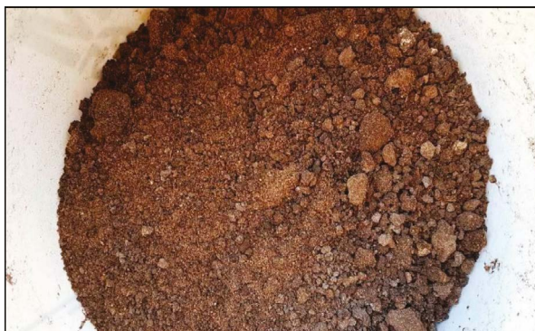
Figura 01: Lodo de esgoto higienizado e estabilizado.
