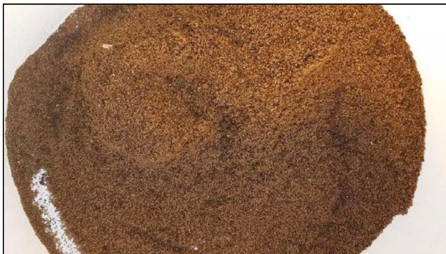
Figura 02: Mistura de areia Média com lodo seco de esgoto.
