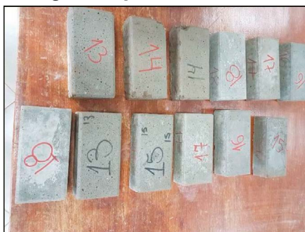
Figura 04: Desmontagem dos pavers .
