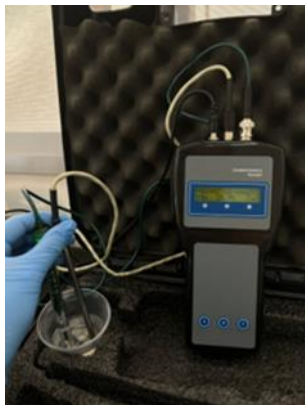
Figura 7. Condutivímetro microprocessador portátil. Fonte: Ishimatsu E.S. (2024).
