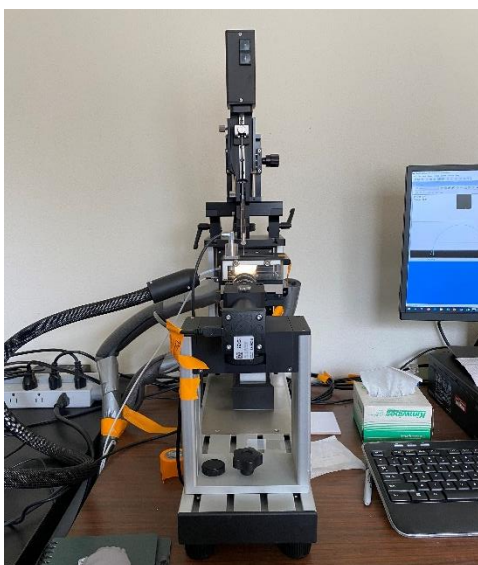
Figura 11 - Equipamento de medição de tensão superficial e ângulo de contato (OCA 15EC).
