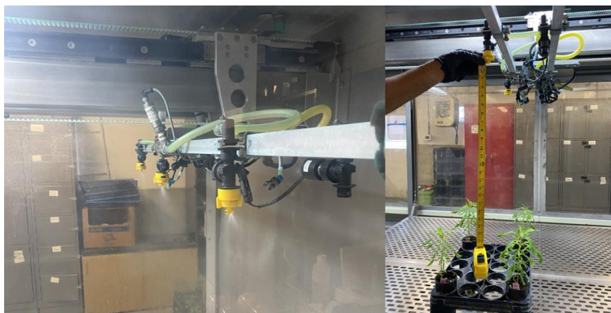
Figura 10 – Simulador de pulverização. Foto: Oliveira, J.V. (2020).
