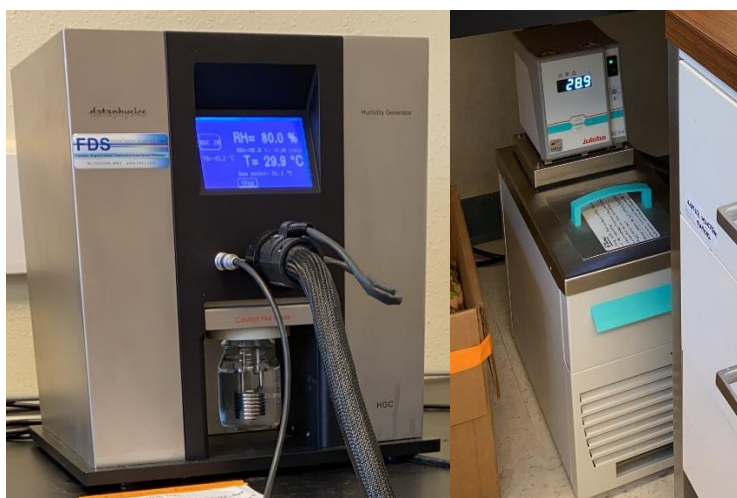
Figura 12 - Equipamentos para controle de temperatura e umidade. Foto: Oliveira, J.V. (2020).
