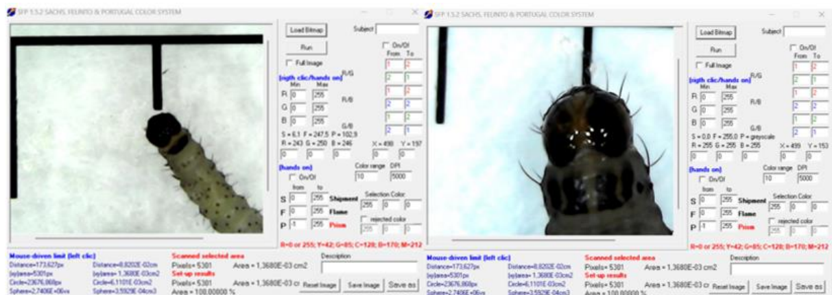
Figura 5. Medição de cápsulas cefálicas de lagartas de Spodoptera frugiperda de primeiro ínstar (à esquerda) e terceiro ínstar (à direita) através do software SFP.
