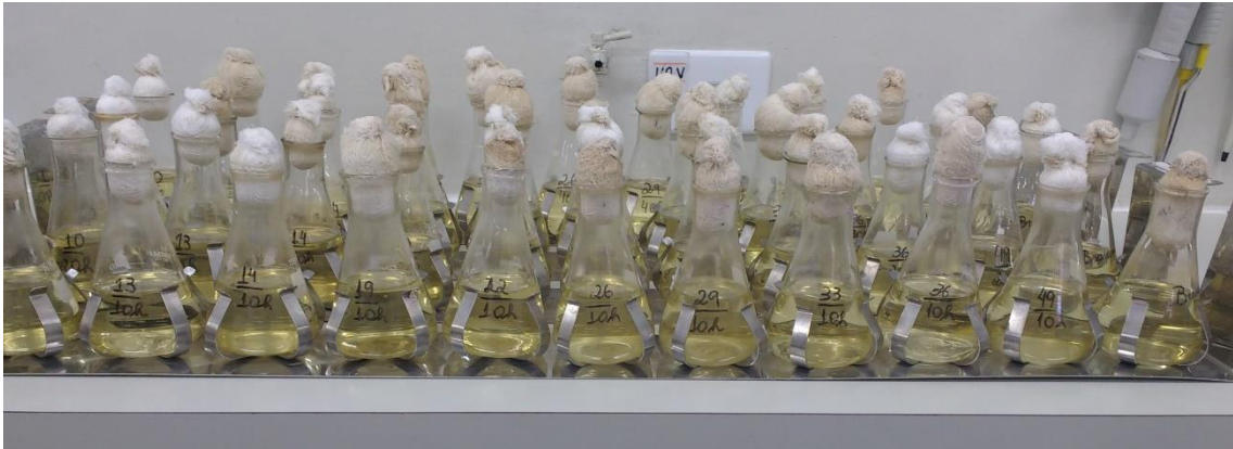
Figura 4.2 – Frascos Erlenmeyer contendo de caldo nutriente para cultivo líquido de bactérias.
