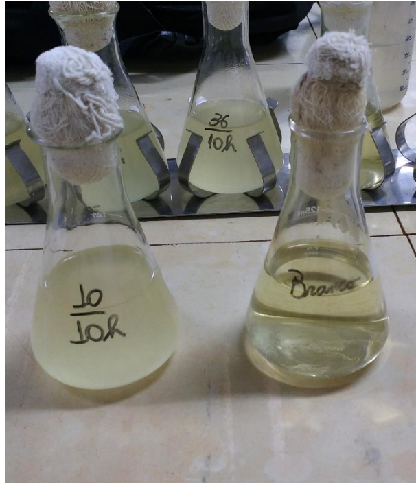
Figura 4.4 – Turbidez do caldo nutriente após período de 10 horas de cultivo contínuo de bactérias, ‘BAC 10’ à esquerda e ‘Branco’ à direita.
