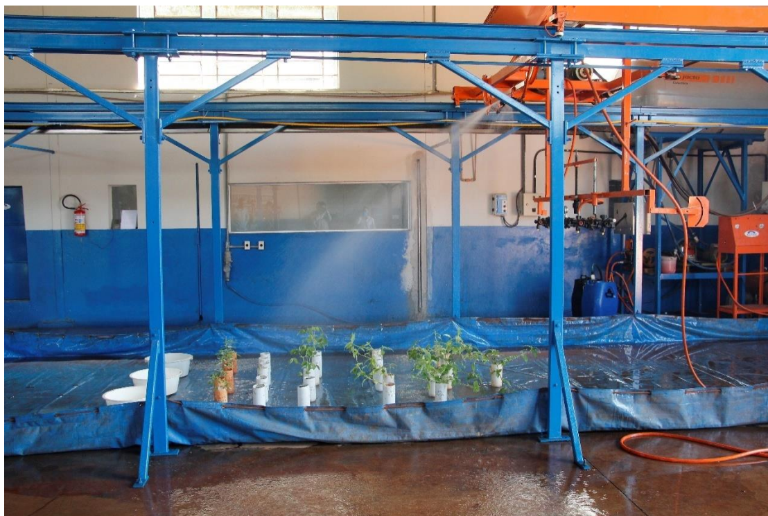
Figura 14 - Simulação de precipitação no experimento de Dicamba + Glyphosate. Foto: NITEC/UENP, Bandeirantes/PR.
