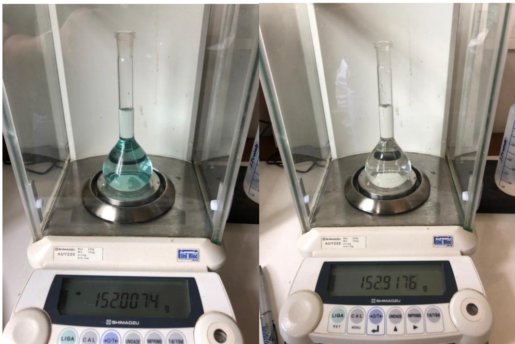
Figura 13 - Pesagem da mistura dicamba + glyphosate e da água para cálculo da densidade. Foto: NITEC/UENP, Bandeirantes/PR.
