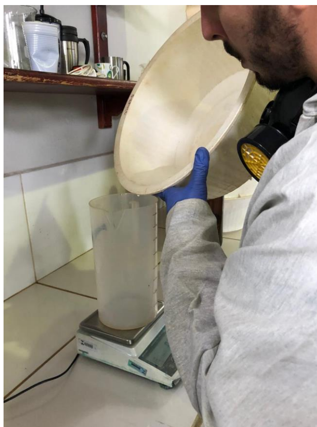
Figura 18 - Pesagem em balança de precisão (0,01g) do volume de água captado pelas bacias coletoras. Foto: NITEC/UENP, Bandeirantes/PR.
