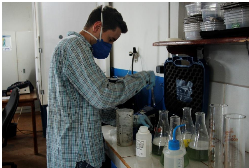
Figura 9 - Medição do pH para a mistura de Dicamba + Glyphosate. Foto: Cunha, w.a.b. (2020).
