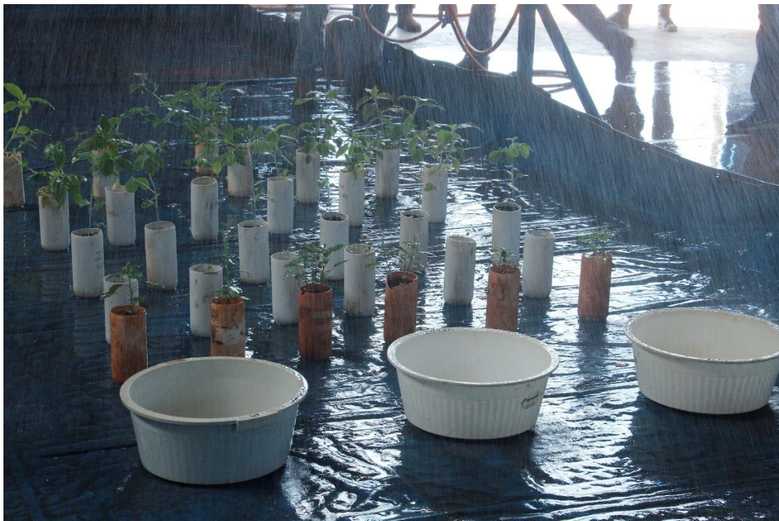
Figura 17- Coletores utilizados na captação do volume de precipitação. Foto: NITEC/UENP, Bandeirantes/PR.
