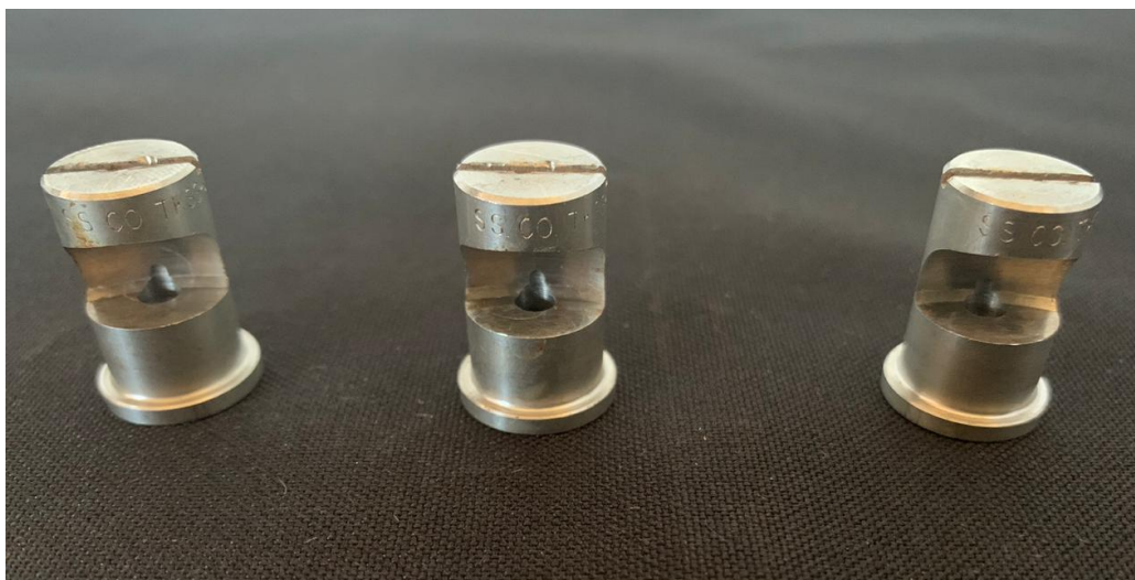
Figura 15 - Pontas defletoras floodjet inox TK-SS utilizadas para a simulação de gotas de precipitação. Foto: NITEC/UENP, Bandeirantes/PR.
