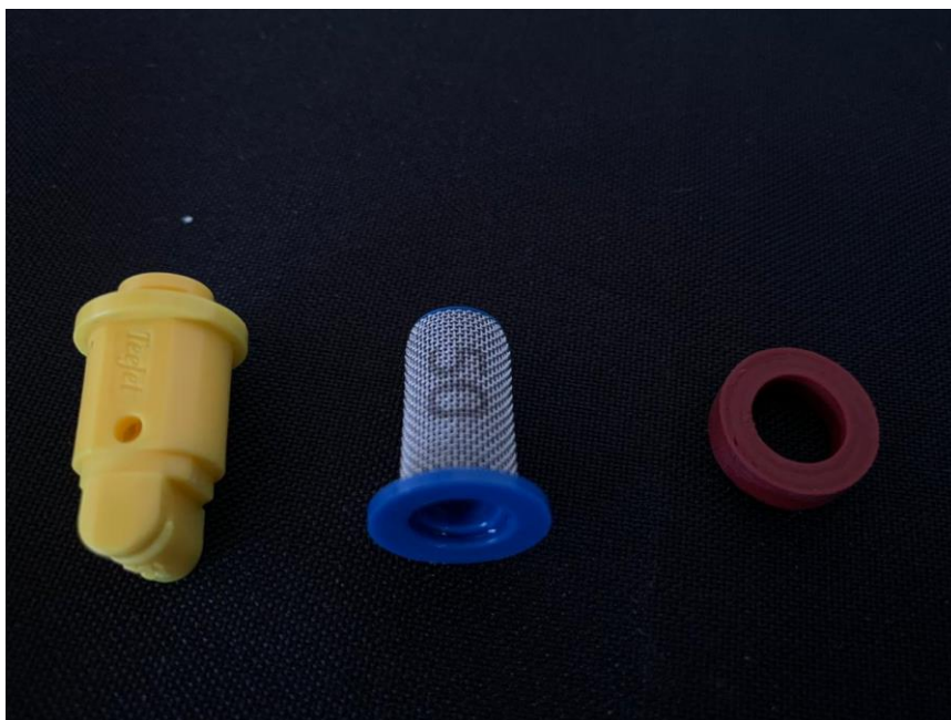
Figura 6 - Ponta de pulverização TTI11002, filtro de malha 50, anel de vedação utilizados para aplicação das misturas. Foto: NITEC/UENP, Bandeirantes/PR.
