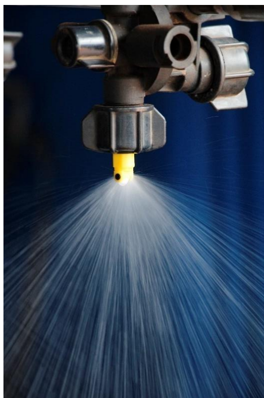
Figura 7 - Ponta TTI11002 no momento da aplicação dos herbicidas 2,4-D + Glyphosate. Foto: NITEC/UENP, Bandeirantes/PR.
